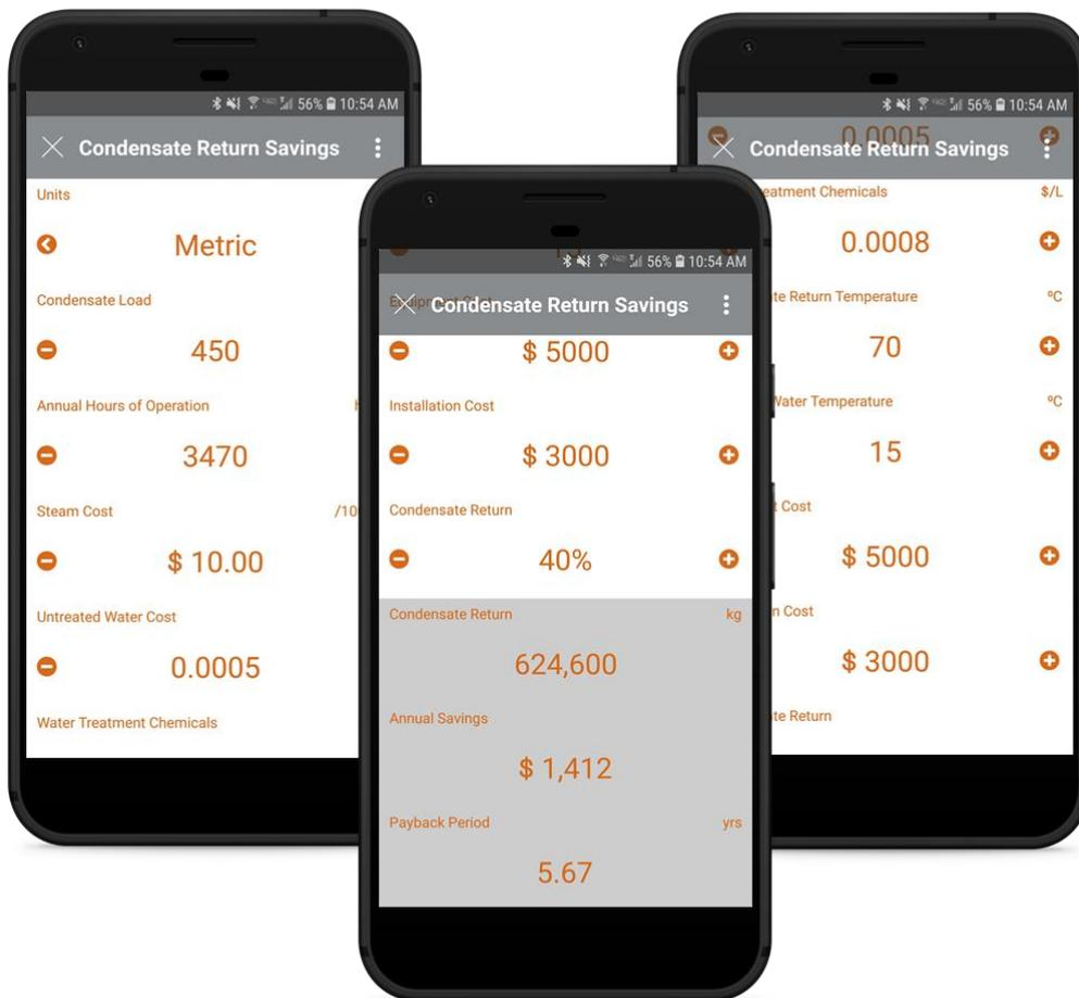
Armstrong-App zur Berechnung von Einsparungen bei der Kondensat-Rückführung in den Boiler über das Dampfsystem
